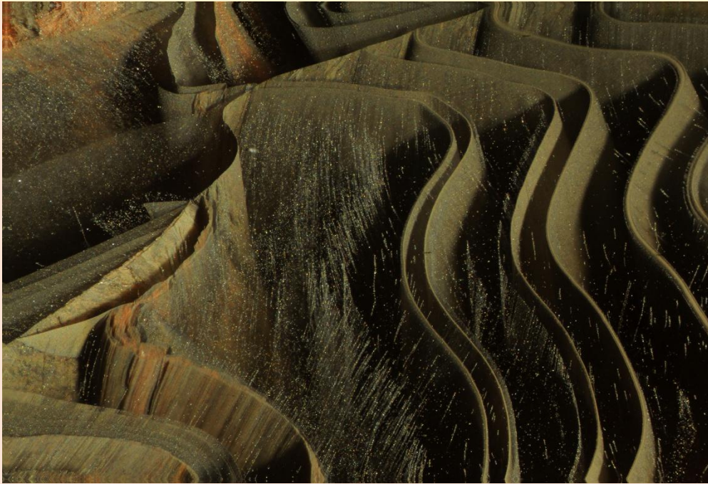
Abb. 14: Raumflächenartig, wie wehende Fahnen aussehende dünne Bänder aus parallel orientierten Magnetitfäden lagern hier in fast ungetrübtem Glas. Bildbreite 4,9 mm.
