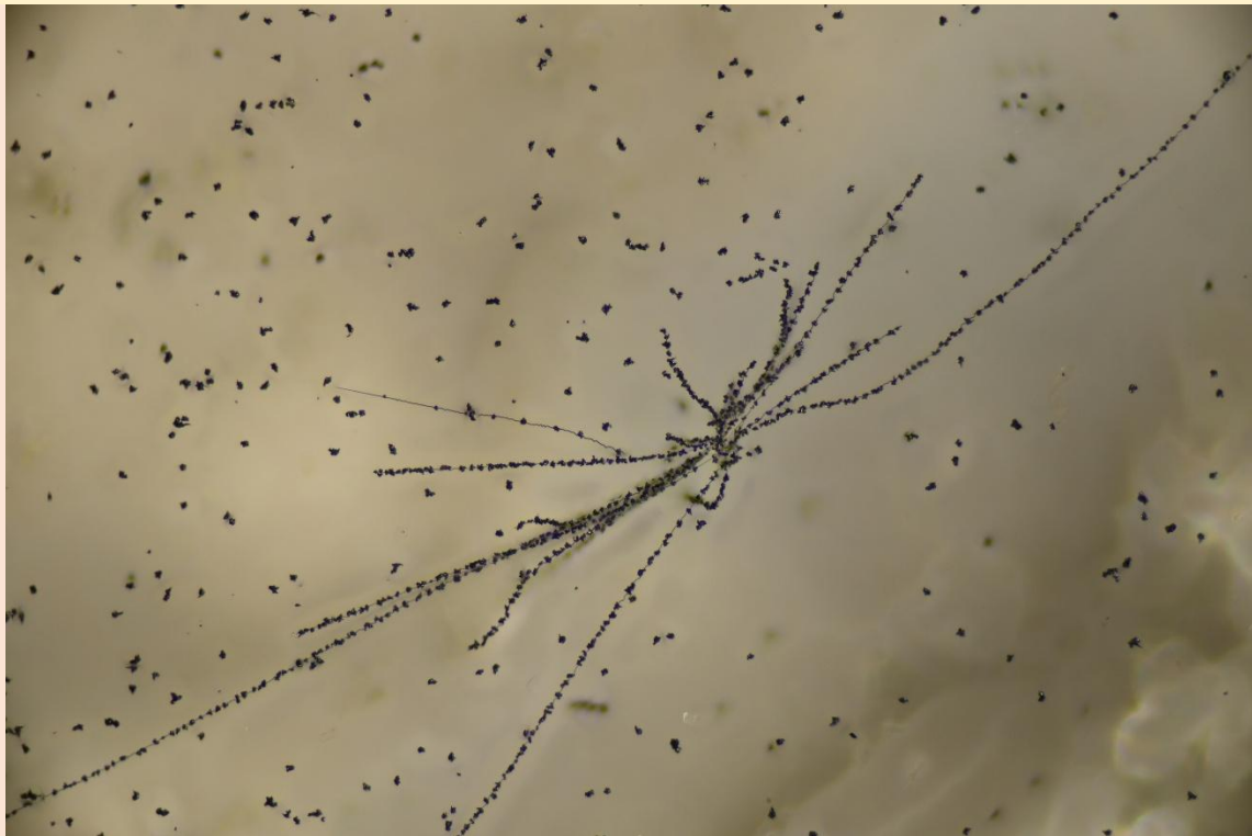
Abb. 6: Spinnentrichit mit nur wenigen Fäden und äquidistant aufgewachsenen Magnetitkristallen. Bildbreite 1,7 mm.
