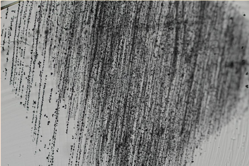
Abb. 12: Häufig trifft man auf dieses Muster: exakt parallel orientierte Magnetitfasern mit großer Fadenlänge. Wie bei den Spinnentrüchten sind die einzelnen Fäden perlschnurartig mit korrodierten Magnetitkristallen besetzt. Bildbreite 1,1 mm.
