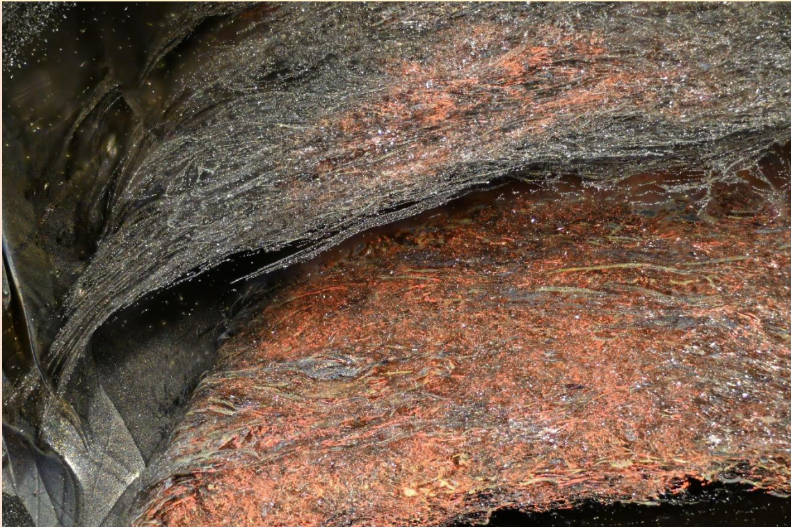
Abb. 16: Hier sind die einzelnen Fäden nur annähernd parallel zueinander angeordnet. Der Farbe nach ist das Baumaterial der roten Fäden Hämatit, dem gängigen Eisen(III) Oxid.
