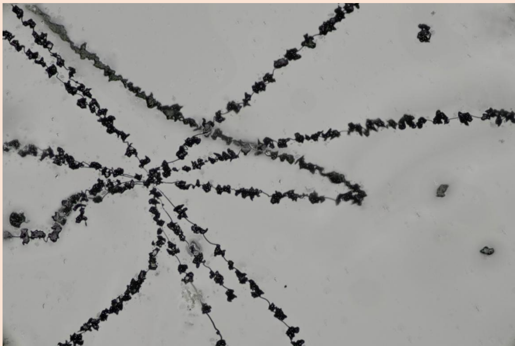
Abb. 9: Der zentrale Bereich eines Spinnentrichits bei höherer Vergrößerung. Die Fäden sind stellenweise deutlich gekrümmt. Ihr Durchmesser liegt bei (nahezu konstant) 0,001 mm. An den korrodierten Magnetitkristallen, die auf den Fäden gewachsen sind, sind keine (ebenen) Kristallflächen zu erkennen. Die Korrosion muss im noch flüssigen Glas stattgefunden haben. Bildbreite 0,45 mm. Von einem (denkbaren) Startkristall/Impfkristall ist nichts zu sehen.
