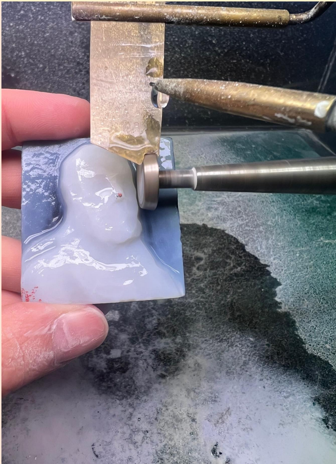
Beginn der Detailarbeit am Diamantschleifrad.
